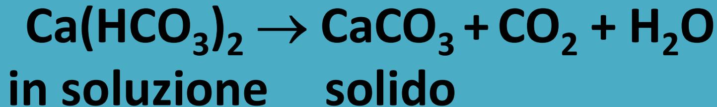
**Frequentemente la formazione di nuovo calcare o di gesso è accompagnata alla formazione di croste nere (adsorbimento di particelle carboniose dall'atmosfera)** <sup>4</sup>
